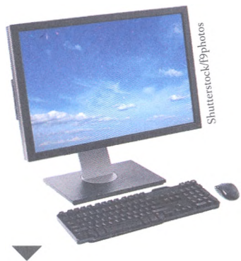
Monitor de computadora. Proporcionalidad de 5:4 y resolución de imagen de 1 280 x 1 024 píxeles.
